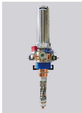
世界初の3周波数のプラズマ加熱装置「ジャイロトロン」
