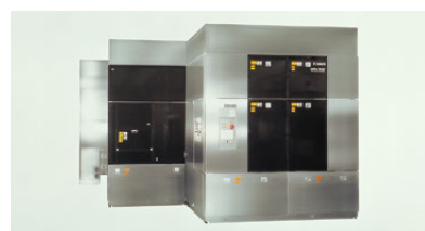
2002年に発売された液晶露光装置
